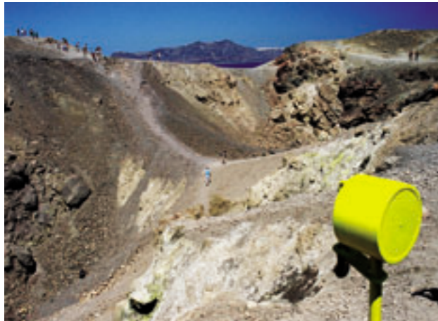
A földrengésérzékelő a világtűrőn keresztül küld rádiójeleket a megfigyelő állomásokra (Szantorini, Nea Kameni, 2000, sz.)
